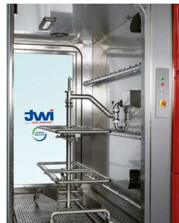
Abb. 8: Reinigungskammer mit Flaschenwagen
